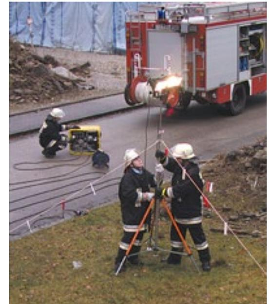
Flutlichtstrahler mit Leitungstrommel und Abzweigstück
