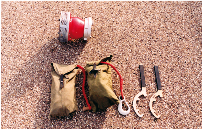
Maschinist legt bereit: 2 Kupplungsschlüssel, Saugkorb, Halte- und Ventilleine
