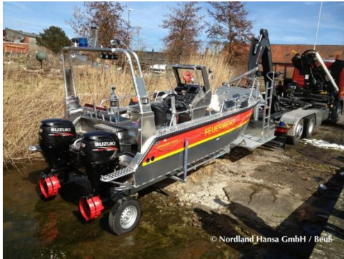
Abb. 14: Absetzen mit Wechsellader
