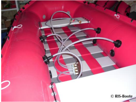
Abb. 9: Vier voneinander unabhängige Luftkammern
