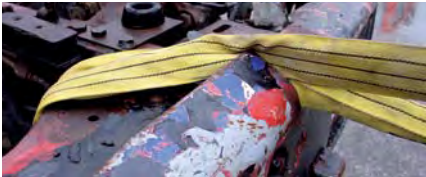
Vorsicht! Hebebänder nicht über scharfe Kanten spannen.
