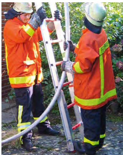
Steckleiter nur mit Einsteckteil verwenden.
