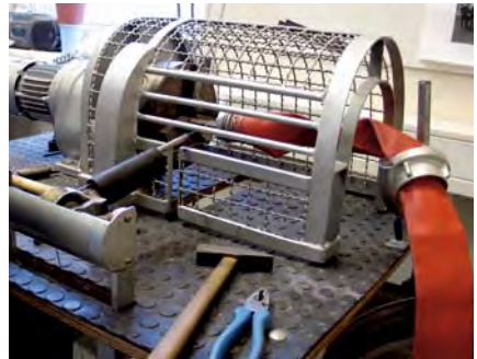
... mit wirksamer Schutzeinrichtung gegen sich lösende Teile
