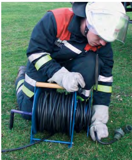
Leitungstrommeln bei der Benutzung ganz abwickeln.
