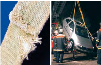
Dieses Hebeband ist ablegereif!
