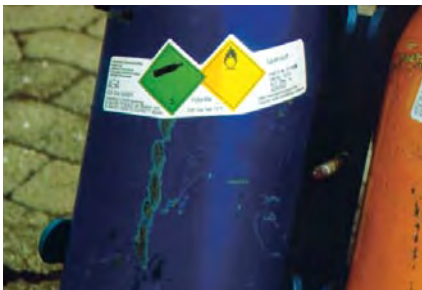
Gefahrzettel an einer Sauerstoffflasche (Transportgefäß)
