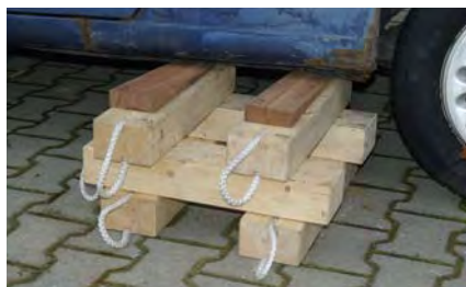
Unterbau durch Rüsthölzer
