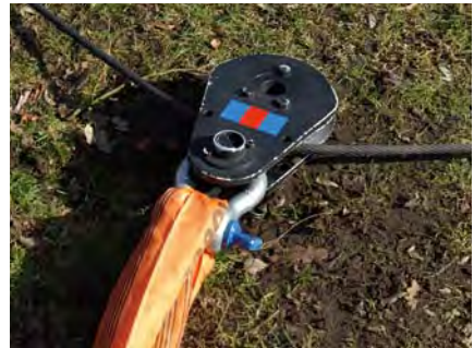
Umlenkung durch feste Rolle
