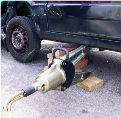
Beim Auseinanderfahren unter Last darf keine gegenläufige Bewegung auftreten.
