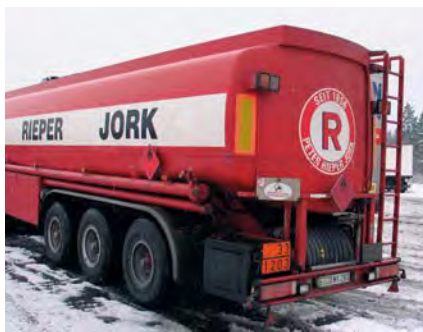
Tankfahrzeug – Warntafel mit Kennzeichnungsnummern und Gefahrezetteln
