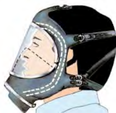
Dichtlinienbereich der Atemschutzmaske
