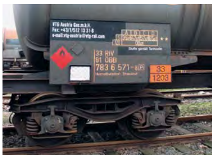
Eisenbahnwaggon – Warntafel mit Kennzeichnungsnummern und Gefahrezettel
