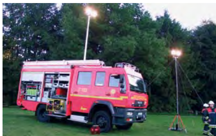
Lichtmast am Löschfahrzeug und abgespanntes Teleskop-Dreibeinstativ
