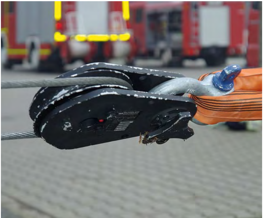
Einsatz einer losen Rolle
