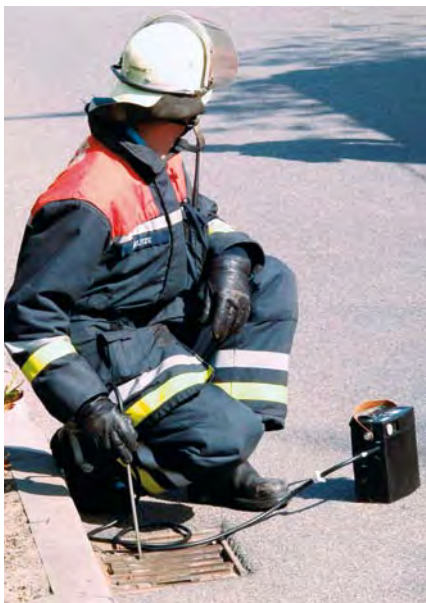
Messgeräte-Einsatz zur Feststellung von Explosionsgefahren
