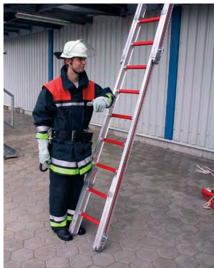
So kann der richtige Anstellwinkel überprüft werden.
