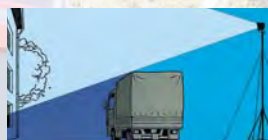
Hoch angeordnete Lichtquellen verringern die Schattenbildung.
