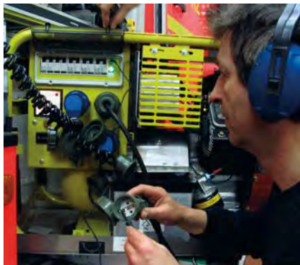
Überprüfung der Schutzmaßnahme eines tragbaren Stromerzeugers
