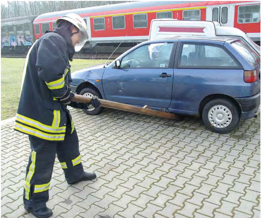
Schnelle Lastbewegung mittels Hebebaum
