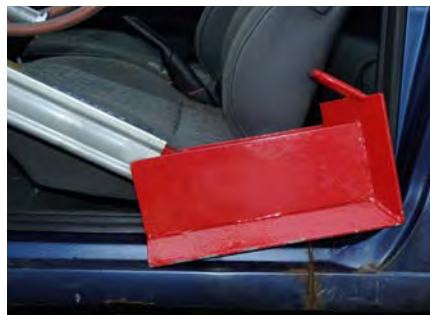
Einsatz eines Rettungszyinders mit Schweller- aufsatz.
