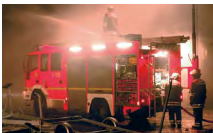
Fahrzeug-Umfeldbeleuchtung und Lichtmast am Löschfahrzeug zur Einsatzstellenbeleuchtung
