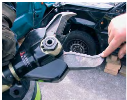
Sichtprüfung der Schneidmesser
