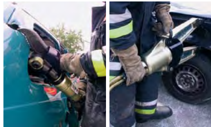
Einsatz eines Schneid- Einsatz eines Spreizers gerätes
