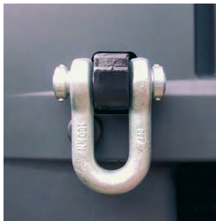
Festpunkt am Feuerwehfahrzeug (160 kN)
