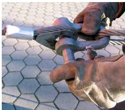
Zugseile und Anschlagseile nur mittels Schäkel verbinden.
