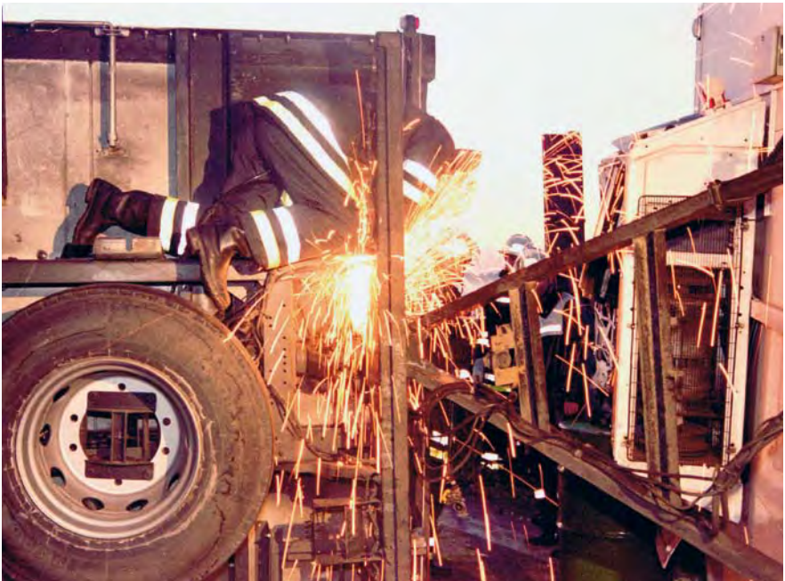
Brennschneiden unter erschwerten Bedingungen nach einem LKW-Unfall
