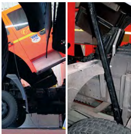
Gekipptes Führerhaus ... mit Sicherung gegen unbeabsichtigtes Absinken
