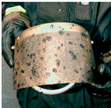
Gesichtsschutz nach starker Wärme-Einwirkung
