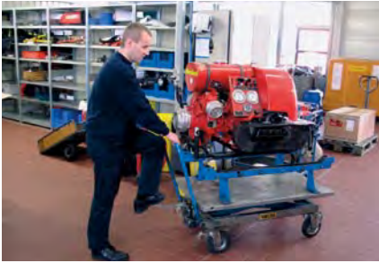
Transportwagen für Tragkraftspritzen mit mechanischer Höhenverstellung
