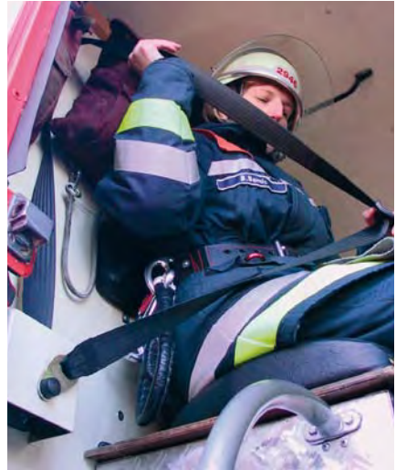
Nachgerüsteter Sicherheitsgurt mit Aufrollautomatik im Mannschaftsraum
