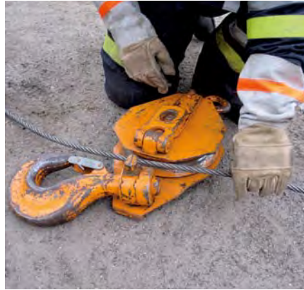
Einlegen des Drahtseiles in die Rolle
