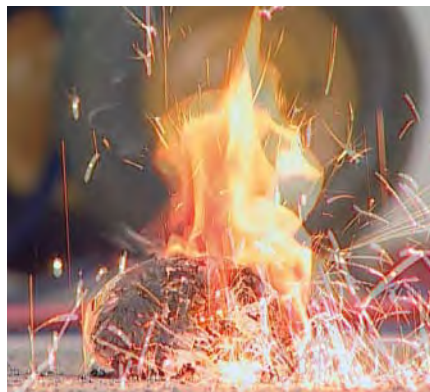
Hohe Zündenergie: Funkenflug bei Brennschneidarbeiten
