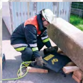
Hebekissen weit einschieben – mind. 75 % unter die Last
