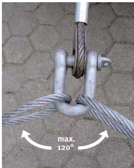
Maximum: Der Seilspitzwinkel beträgt 120 °.
