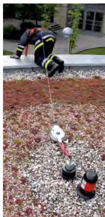
Auffanggurt mit Höhensicherungsgerät
