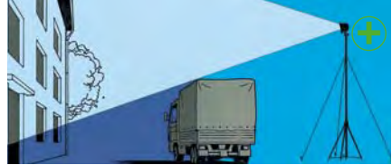
Hoch angeordnete Lichtquellen verringern die Schattenbildung.
