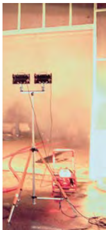
Einsatzstellenbeleuchtung durch Halogen-Flutlichtstrahler auf Teleskop-Dreibeinstativ
