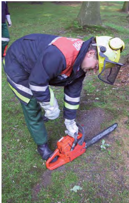
Sicherer Motorsägeneinsatz – Schutzausrüstungen und sichere Motorsägen sind Voraussetzung.
