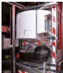
Reinigungsstation am Löschfahrzeug mit fließendem Wasser, Reinigungs- und Pflegemitteln aus Direktspendern und Einmalhandtüchern
