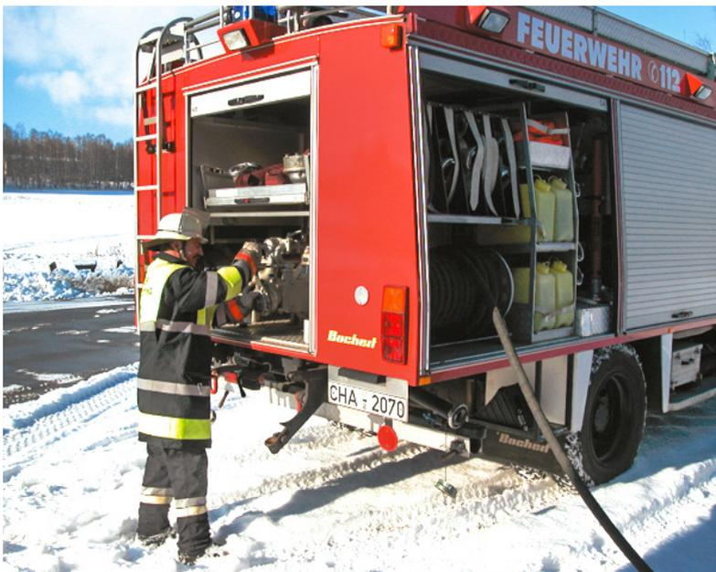
Alle Dichtungen der Pumpe mit Frostschutzmittel-Wassergemisch benetzen
