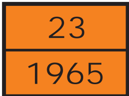
Warntafel an Tankfahrzeugen mit Flüssiggas (hier: Gemisch)
