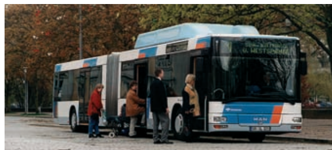
Erdgasflaschen oder Flüssiggasbehälter auf dem Dach eines Omnibusses
