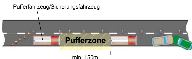
Bild 8: Mindestanforderung Sicherungsfahrzeug mit Pufferzone
