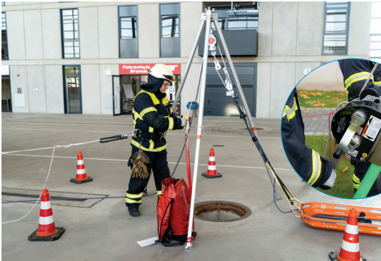
Abb. 15 und 16 Dreibock / Dreibein mit Rollgliss Personenseilwinde
