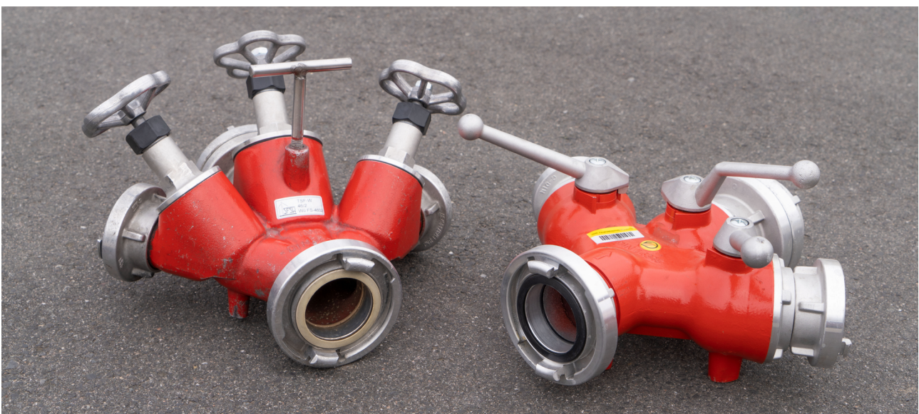
Verteiler mit Niederschraubventilen (links) und Verteiler BK mit Kugelhähnen (rechts)
